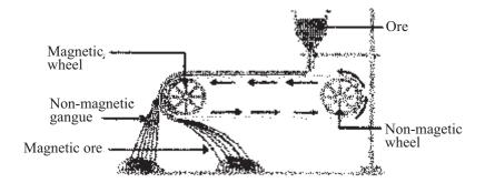
Fig. 16.4.: Magnetic Separation
